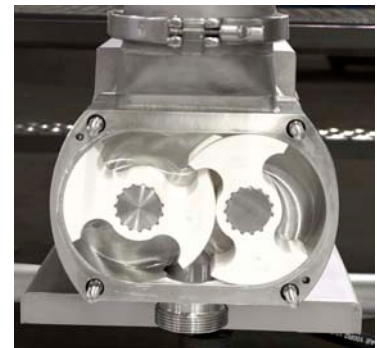
Detalle del rotor de la bomba sin el cedazo de cubierta
