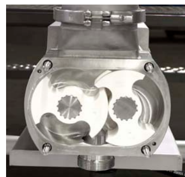
Pokazany szczegół wirnika pompy ze zdjętą płytą pokrywy.
