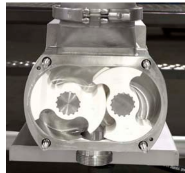
Detalhe do rotor de bomba sem a placa de proteção
