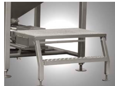
Откидная платформа для облегчения доступа для инспекции и очистки бункера
