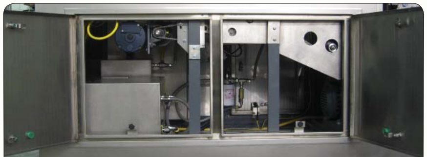
相对凸轮和拨叉, 更高的每分钟成型次数; 两个摇臂部件, 更易更换部件
